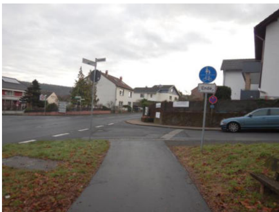
Abbildung 13: Fehlende Überführung auf die Fahrbahn am Ortseingang Oberrodenbach (links), ungesicherte Führung auf die Fahrbahn „Vorm Stichel“ (rechts) (Quelle: Eigene Aufnahmen)
