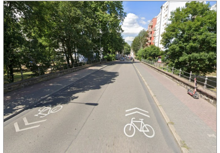
Abbildung 2: Foto Piktogramm-kette mit Winkelpfeilen bei Aufhebung der Benutzungspflicht, Rödelheimer Landstraße, Frankfurt (eigene Aufnahme)
