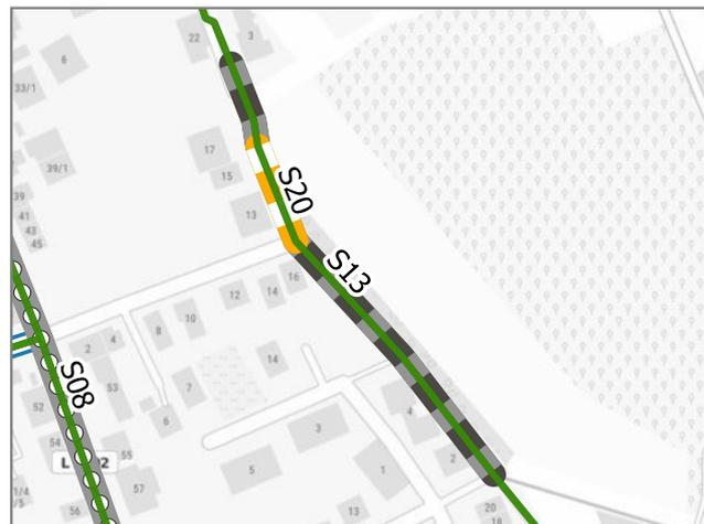
Situation: Der betrachtete Abschnitt verfügt über eine schadhafte wassergebundene Decke (mit teilweise grobem Schotter). Die parallel verlaufende Kirchstraße verfügt über keine Radverkehrsanlagen.
