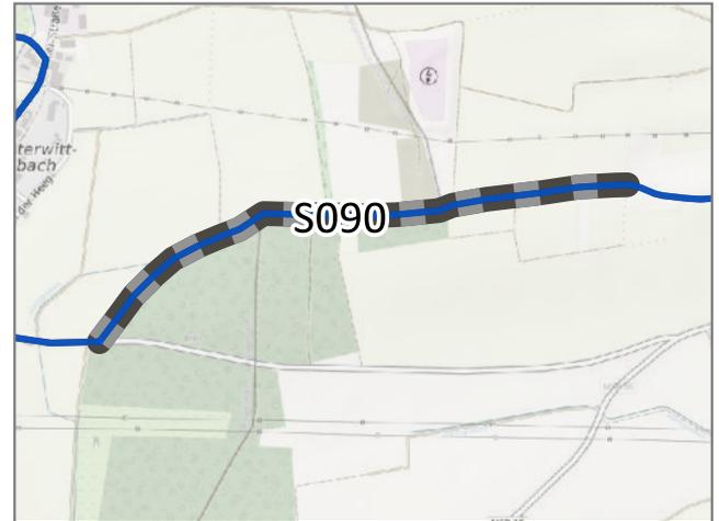
Situation: Der betrachtete Abschnitt verfügt über eine schadhafte wassergebundene Decke mit teilweise losem Untergrund. Auf der parallel verlaufenden MSP 36 gibt es keine Radverkehrsanlagen.
