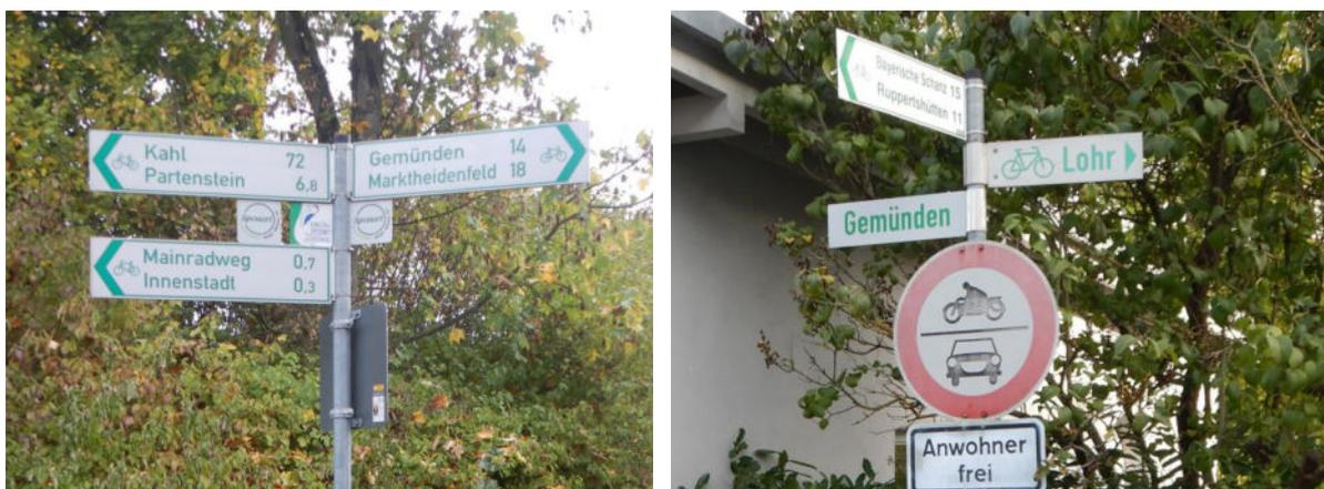
**Abbildung 12:** Pfeilwegweiser mit Einschubplaketten nach den aktuellen FGSV-Standards in Lohr a.Main (links) und unterschiedliche Fahrradwegweiser, teilweise ohne Kilometerangaben, in Gemünden a.Main (rechts) (Quelle: eigene Aufnahme)
