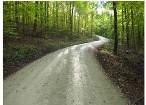
Abbildung: Beispiel gut befahrbare wassergebundene Decke
