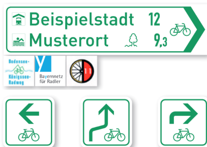
Abbildung 13: FGSV-konforme Pfeil- (oben) und Zwischenwegweiser (unten) (Quelle: RadlLand Bayern)
