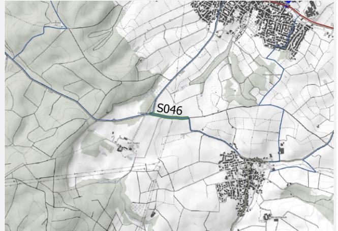
**IST-Zustand:** Es existiert kein straßenbegleitender Geh- und Radweg. Der Radverkehr wird auf der Fahrbahn geführt. Die zulässige Höchstgeschwindigkeit liegt (abschnittsweise) bei 100 km/h. Es gibt keine geeignete Alternativverbindung.
