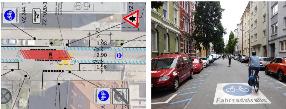
Abbildung 13: Planung Fahrradstraße / eingerichtete Fahrradstraße mit taktilem Sicherheitstrennstreifen zum „Gefahrenbereich Kfz-Türen“ in Offenbach am Main (Quelle: Eigene Darstellung / eigene Fotos)
