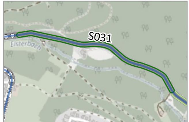
Situation: Es existiert kein straßenbegleitender Geh- und Radweg. Der Radverkehr wird auf der Fahrbahn geführt. Die zulässige Höchstgeschwindigkeit liegt bei 60 km/h. Es gibt keine geeignete Alternativverbindung.
