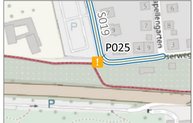
Situation: Die beiden Kurven an der betrachteten Stelle sind eng und für den Radverkehr schlecht befahrbar. Der Übergang zwischen Fahrbahn und Geh-/Radweg ist im Löserweg nicht sicher gestaltet. Der Bordstein ist nur auf einem kurzen Stück abgesenkt. Für Radfahrende, die aus Norden des Löserwegs kommen, ist die Wegweisung, um auf den südlichen Geh-/Radweg zu kommen, schlecht erkennbar.
