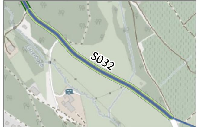
Situation: Der vorhandene Gehweg ist deutlich zu schmal. Es existiert kein straßenbegleitender Radweg. Der Radverkehr wird auf der Fahrbahn geführt. Die zulässige Höchstgeschwindigkeit liegt bei 60 km/h.
