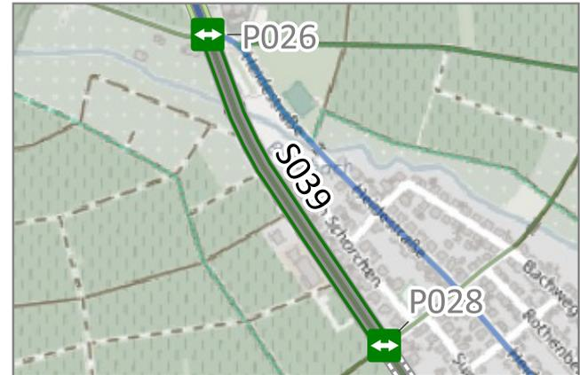
Situation: Es existiert kein straßenbegleitender Geh- und Radweg. Der Radverkehr wird auf der Fahrbahn geführt. Die zulässige Höchstgeschwindigkeit liegt bei 70 km/h.
